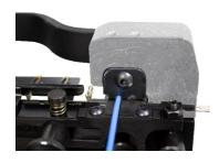
Schritt 5 Handzange vollkommen schließen, bis Sicherheitsratsche das Öffnen des Werkzeuges möglich macht.
