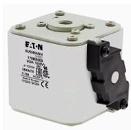
**Cartuccia fusibile, corsa rapida, 900 A, AC 1000 V, 125 kA, size 3, 74 x 92 x 76 mm, aR, IEC, UL, indicatore tipo K**
