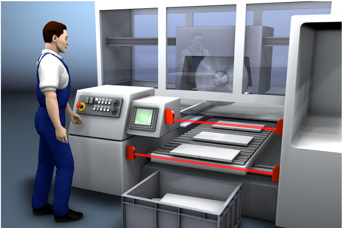
Bild 5.2: Zugangs-/Eingreifsicherung an Sägemaschine
