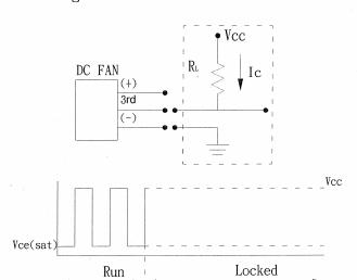
Vcc=Vcc(Max) Ic=4mA(Max) RL≧Vcc/Ic
